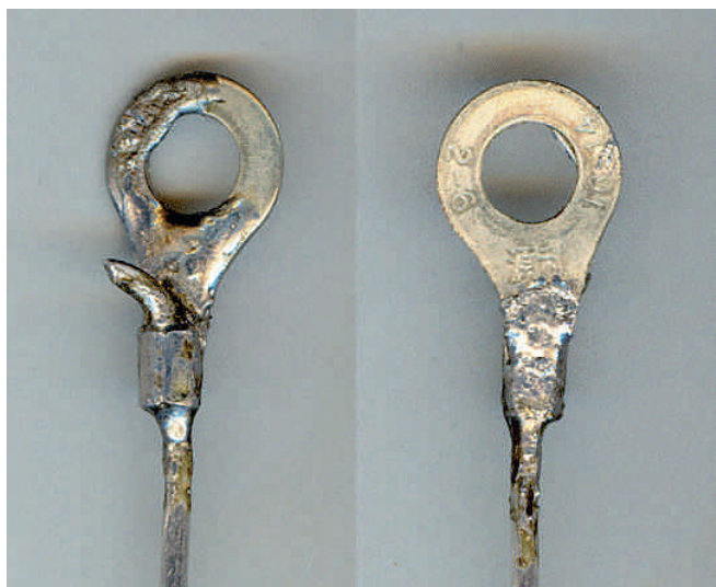
Soudure (généreuse) du fil sur un oeillet en acier galvanisé. Remarquez la manière dont la soudure a mouillé le fil
